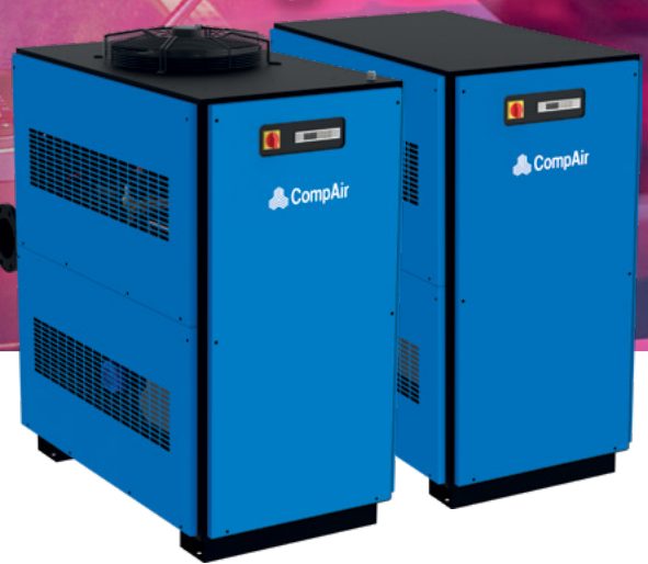
CDA533F-ES, CDA700F-ES & CDA800F-ES – Sècheurs cyclique ISO Classe 4 (point de rosée sous pression de 3°C) (R513A) - refroidis à l'air et à l'eau.
