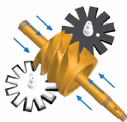
Las cargas axiales actúan en ambos lados del rotor principal
