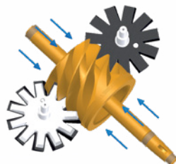
Obciążenia osiowe działają po obu stronach głównego wirnika.
